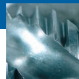
■ Krawędź skrawająca po wykonaniu 1.000 gwintów
